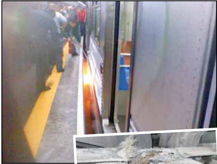
Mau funcionamento de fusível foi a causa do incêndio em um dos carros de trem da Linha 1 - Azul, na manhã do dia 23/09
